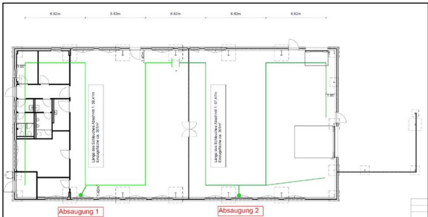
Abbildung 13: Grundriss Tirschenreuth mit Eintrag der Dranagerohre sowie der vorbereiteten Absaugpunkte (Quelle List Bau, Munchen)
